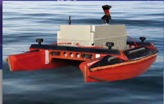
Bild 4: Ferngesteuertes Boot für Peilungsmessungen.
