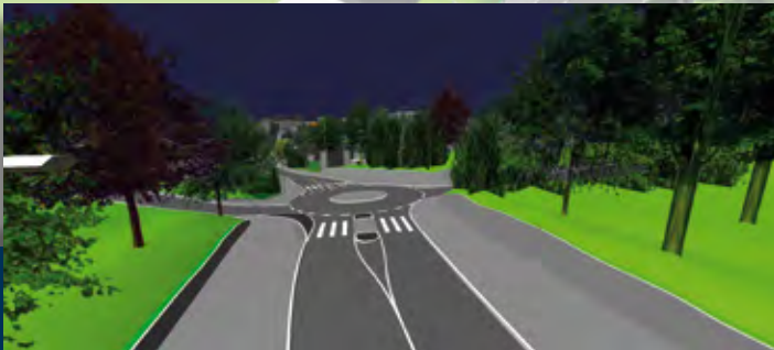
Mini-Kreisverkehr mit 6 % Längsneigung und überfahrbarer Mittelinsel.
