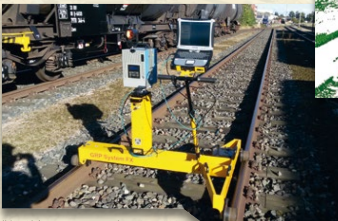
Bild 3: Gleismesssystem Amberg GRP5000.
