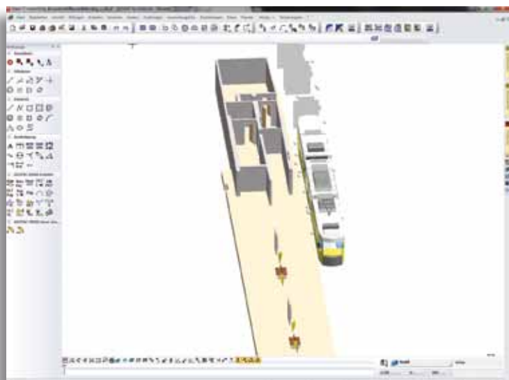
3D-Darstellung der Bahnsteigkante, des Fahrzeugs, der Hüllquerschnitte und der Zwangspunkte.
